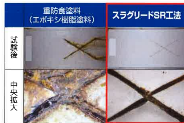
JIS K 5600-7-9 塗膜の長期耐久性(複合サイクル試験) 塩水噴霧(5%NaCl,35℃,2h)→乾燥(60℃,25%RH,4h)→湿潤(50℃,98RH,2h)
